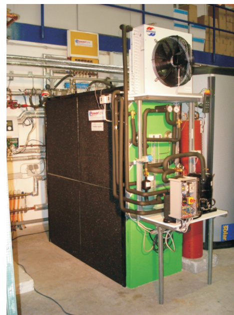
WKS Compressoreinheit im Prüffeld mit PowerTank WKS Zellen Speicher vakuum-isoliert
