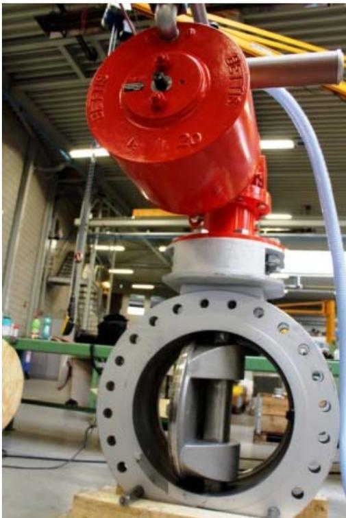
**Die Pneumatiksteuerung im Aktor hat die Aufgabe, die unten zu sehende 24-Zoll-große Drosselklappe im Falle von Überdruck binnen einer halben Sekunde zwecks Druckausgleichs zu öffnen**
