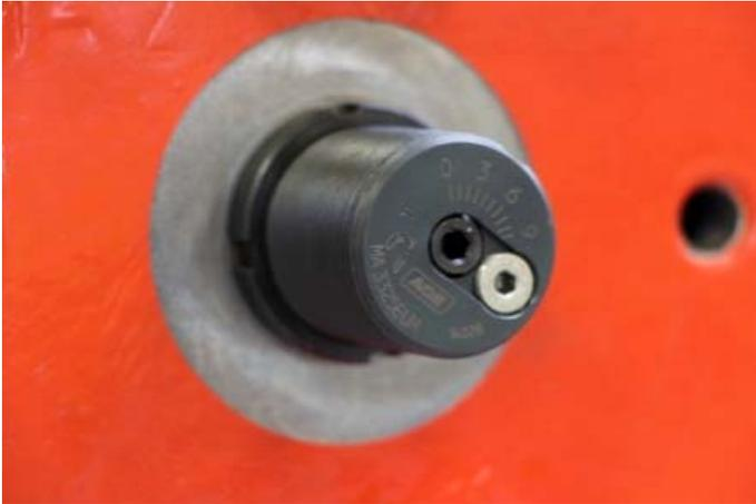
**Detail des von der Doedijs Group International (DGI) konstruierten Aktors mit integriertem, einstellbarem ACE Industriestoßdämpfer für ein Kompressorpaket einer Erdgasraffinerie**
