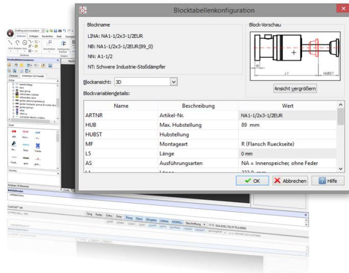
**Bildunterschrift:** Ingenieure können direkt innerhalb des CAD Systems kostenlos auf Millionen CAD Modelle namhafter Hersteller zugreifen. Anschließend kann das gewünschte CAD Modell direkt als 3D-, oder in verschiedenen 2D Ansichten, in CorelCAD geladen und für die Konstruktionsarbeiten herangezogen werden.
