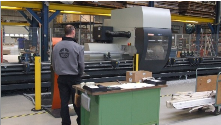
Sägen und Bearbeiten auf derselben Maschine. Mit dem Winkelkopf können Profile auch von unten bearbeitet werden.
