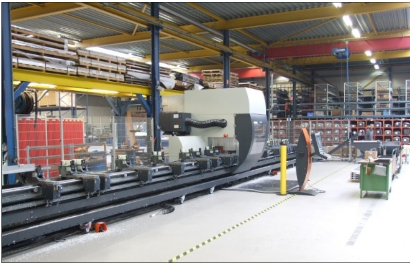
VRR setzt ein SBZ 151 mit 18 m langem Maschinenbett ein. Das Stabbearbeitungszentrum kann auch im Pendelbetrieb mit zwei Stationen arbeiten.
