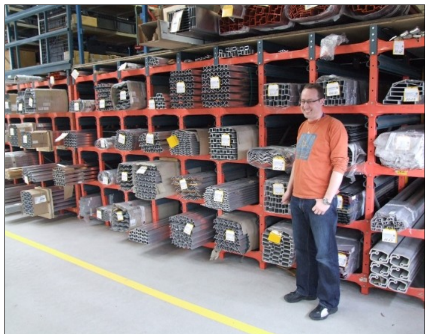
Peter van Tulden, Programmierer bei VRR, zeigt das Profillager mit über 150 verschiedenen Profilen, die auf dem Stabbearbeitungszentrum bearbeitet werden.
