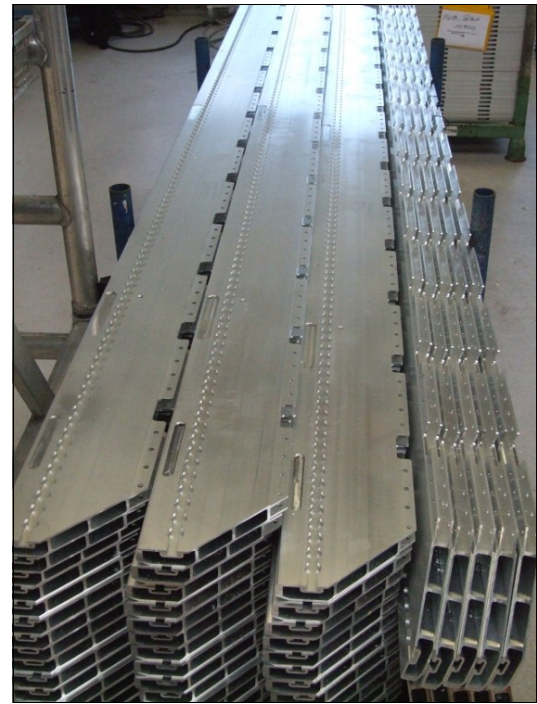
Kreistaschen, Langlöcher, Senkungen, Schlitze, Bohrungen, Rechtecke, Klinkungen und Sägeschnitte – der 3 D-Konverter erkennt Standardbearbeitungen und programmiert diese automatisch.
