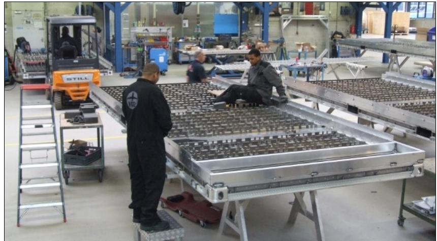
Zusammenbau eines Frachtcontainers bei VRR. Das Unternehmen bietet eine breite Produktpalette an.
