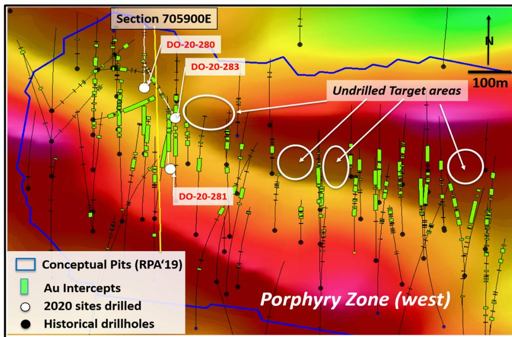
**Abb. 1:** Bohrplan auf aeromagnetischer Basis, der die Hauptbohrlöcher des Jahres 2020 im westlichen Teil der Porphyry-Zone und die Goldabschnitte zeigt. Beachten Sie zwei Cluster mit kontinuierlicheren Goldmineralisierungen, von denen die östlichste noch relativ spärliche Bohrungen aufweist.
