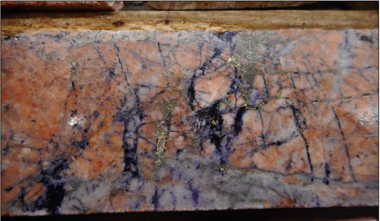
**Abb. 4: Ausgewählter Kern aus DO-20-281, aus dem Intervall 152-153m, der einen Gehalt von 4,35 g/t Au aufwies.** NQ-Kern = NQ-Kern mit 47,6 mm Durchmesser. Beachten Sie, dass dieser Kern nicht unbedingt repräsentativ für alle Douay-Mineralisierungen ist.
