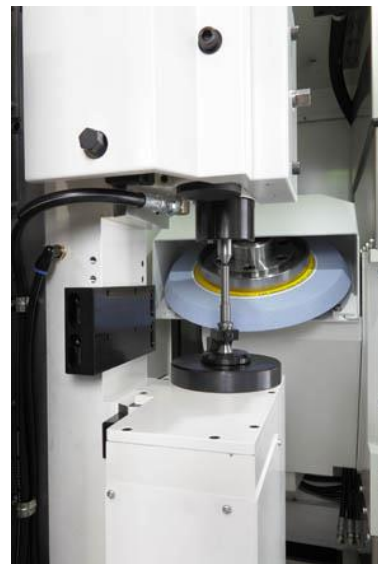
Bild Nr. 04-04 TT_Schleischeibe.jpg Die neue Shigiya GAV ist als Schrägeinstichmaschine konzipiert und schleift bei Werkstücken in einer Aufspannung Durchmesser und Schulter.
