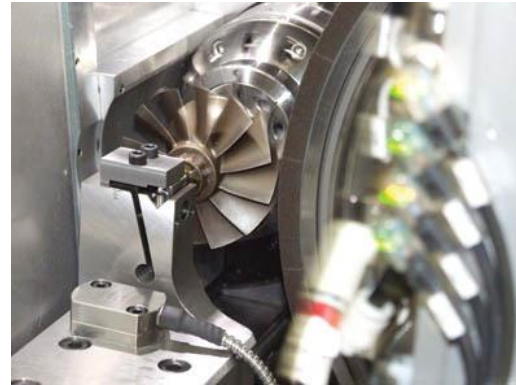
Bild Nr. 04-02 TT_CMT-Turbo.jpg Mit der neuen Doppelspindel-Rundschleifmaschine Vector Twin Mark IV lassen sich zum Beispiel Turboladerwellen feinstbearbeiten
