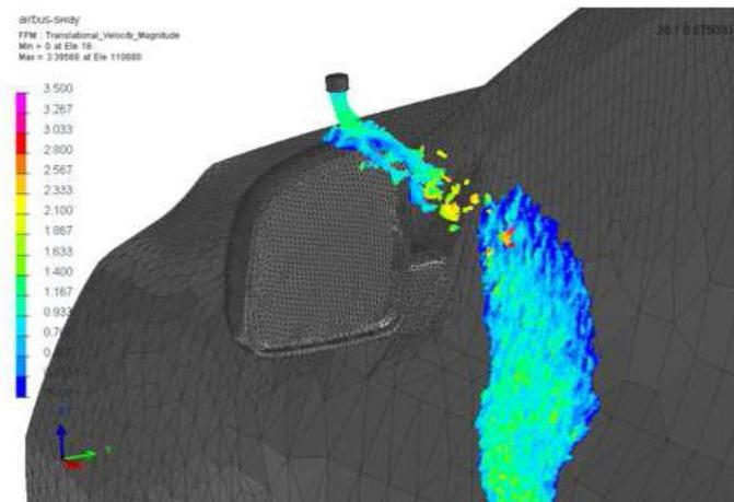
Image: Écoulement d'eau sur la vitre conducteur, simulé avec ESI Virtual Performance Solution.
