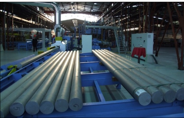
Die Aluminium-Pressbolzen werden im Ofen (links hinten) erhitzt und dann in die Presse geschoben.
