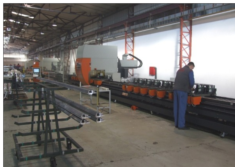
Das 5-Achs-Zentrum SBZ 151 kann auch im Pendelbetrieb eingesetzt werden.
