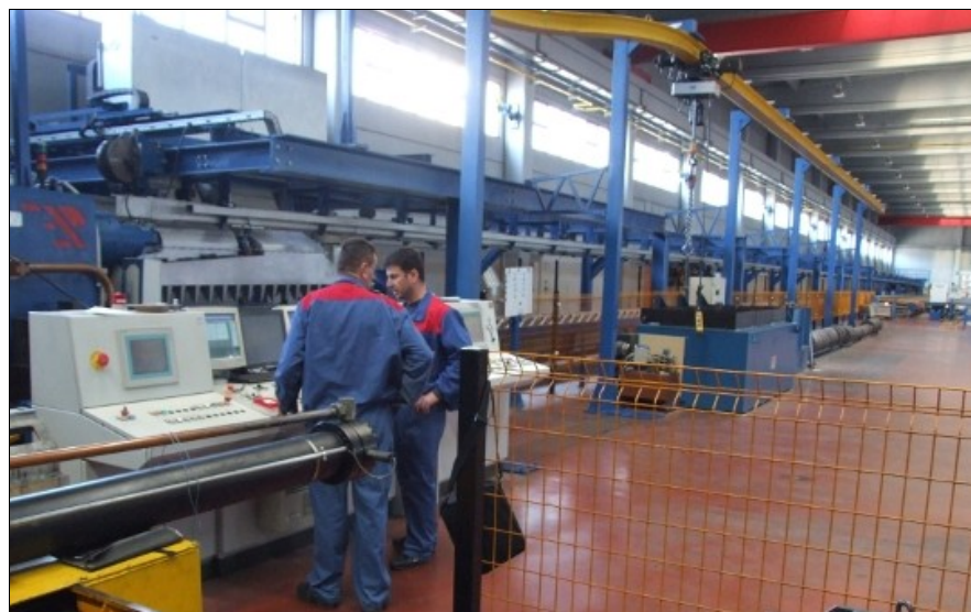
Viel Platz zum Strangpressen. Die Profile können über 50 m lang ausgezogen werden.
