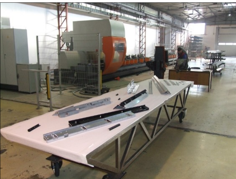
6-Seiten-Bearbeitung am ruhenden Profilstab: So sind auch empfindliche Profile vor Beschädigungen geschützt.
