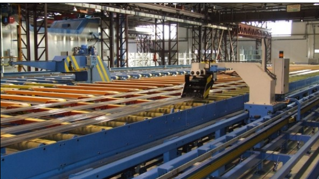
Nicht zu schnell und nicht zu langsam muss der Greifer die Alu-Profile vom Pressmaul wegziehen.
