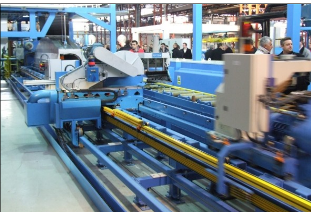
Der Greifer fährt Richtung Säge, um die durch's Pressmaul gedrückten Profile anzunehmen.
