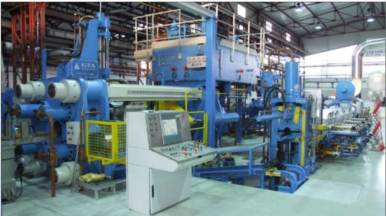
Die neue Aluminiumstrangpresse bei FEAL hat eine Presskraft von 1.400 Tonnen. Das Unternehmen verfügt über mehrere Pressen mit einer Presskraft bis zu 2.500 Tonnen.
