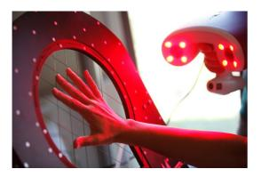
Mittels portablem 3D Scanner wurden jeweils 48 Längen- und Umfangsmaße einer Hand präzise erfasst und ausgewertet.
