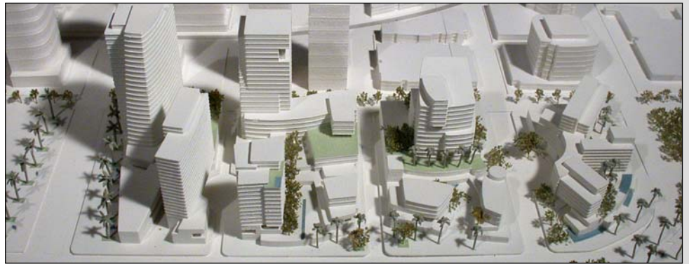
Einfaches Modell einer am Wasser gelegenen Gebäudegruppe mit Landschaft in San Diego für eine Ausschreibung, gedruckt mit ZPrinter 310 Plus
