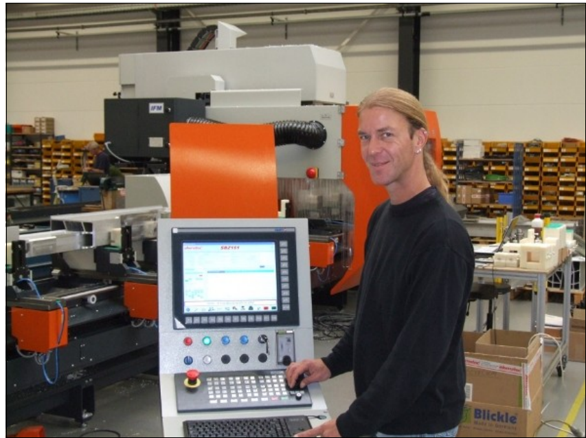
Michael Rau, Anwendungsprogrammierer der CAMäleon Produktionsautomatisierung GmbH, hat die komplizierten Bearbeitungen programmiert und am 5-Achs-Stabbearbeitungszentrum SBZ 151 von elumatec getestet.
