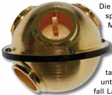
Die GPS-Kugeln (general purpose sphere) erfüllen keine spezielle Messaufgabe, sie sind fast überall geeignet. Jede GPS-Kugel hat eine Schikane (Lichtblende) in der Äquatorialebene bei 45°, um den direkten Lichtaustausch zwischen 0° und 90° zu unterbinden. Im speziellen Einsatzfall Laserleistungsmessung an divergenten Laserdioden kann es passieren,
