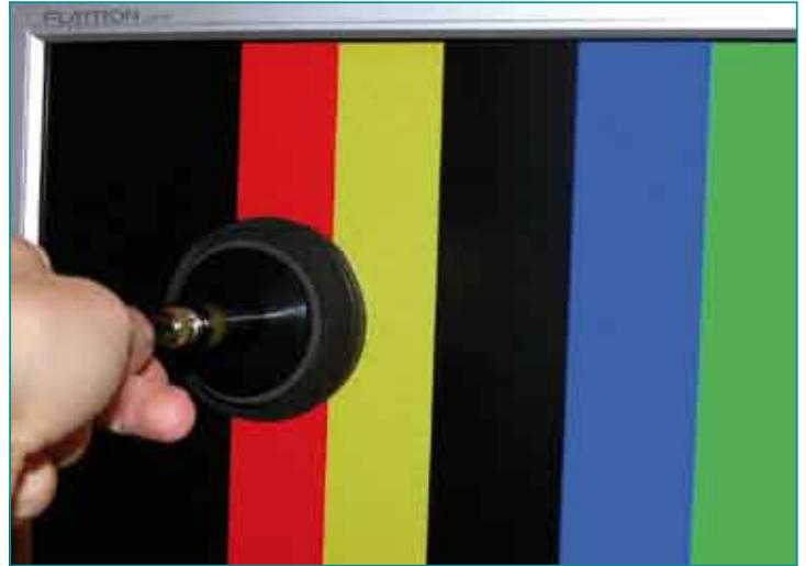
Luminanzmesskopf mit Gummiabschirmung GRO-265 an TFT-Monitor
