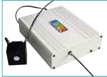
Kugel mit HR-Spektrometer
