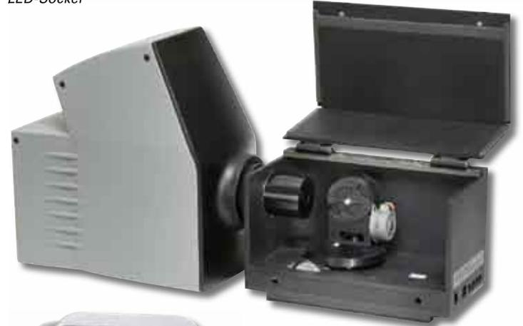
LED-Goniometer mit Spektralradiometer
