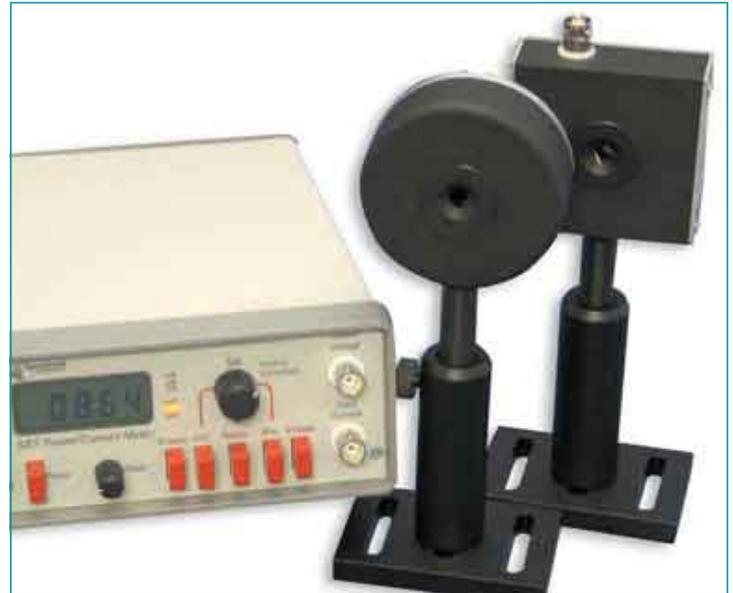
TRAP-Detektoren mit 99% Quanteneffizienz und < 1% Kalibrierunsicherheit
