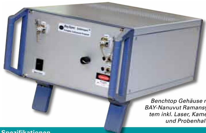
Benchtop Gehäuse mit BAY-Nanuvut Ramansystem inkl. Laser, Kamera und Probenhalter
