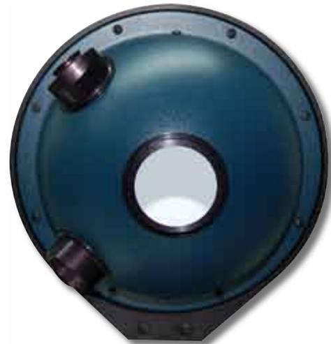
LPM-Kugel mit Detektor und Spektrometeranschluss
