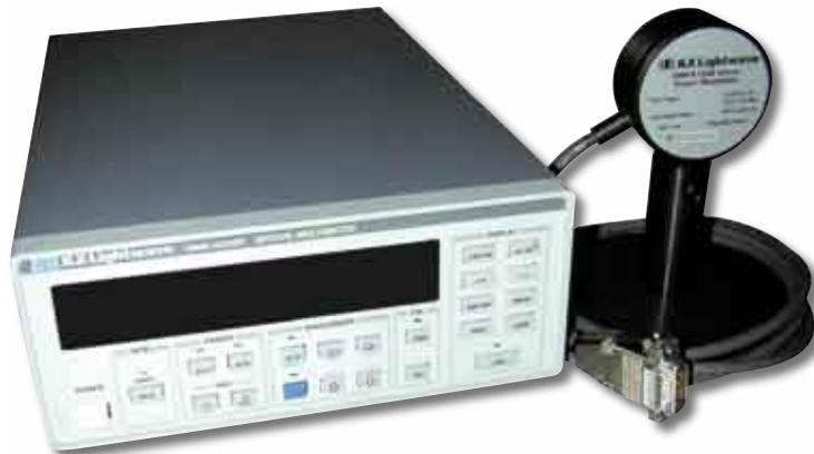
Optisches Multimeter OMM-6810B mit Messkopf
