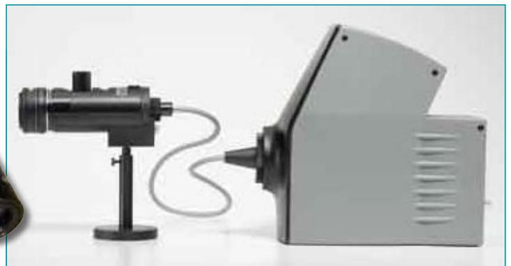
High-End Teleradiometer mit RadOMA und Visiereinrichtung
