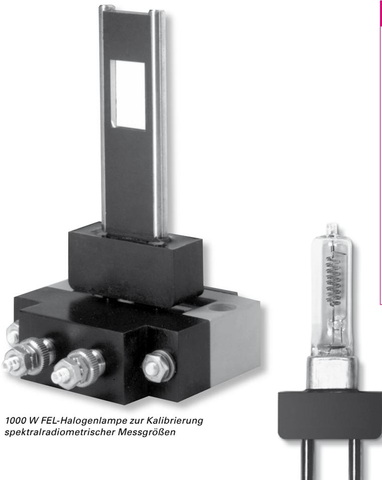
1000 W FEL-Halogenlampe zur Kalibrierung spektralradiometrischer Messgrößen
