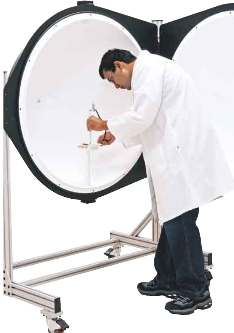
Geöffnete Ulbrichtkugel mit 1 m Durchmesser und Probentisch
