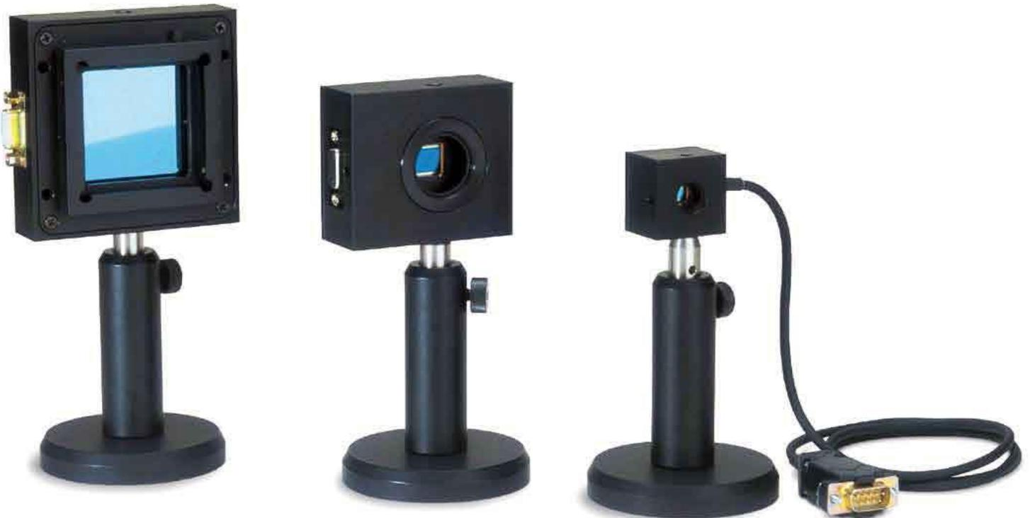
Positionsempfindliche Module in robustem Alu-Gehäuse
