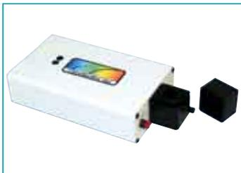
Lichtquelle mit Küvettenaufnahme
