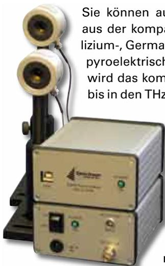
Delta Joule- und Radiometer analog und digital
