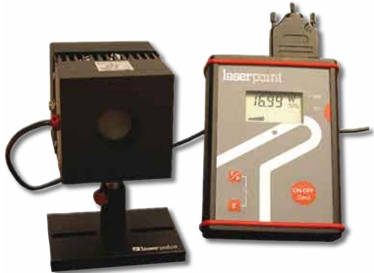
Anzeigegerät LPT-PLUS-USB mit Messkopf
