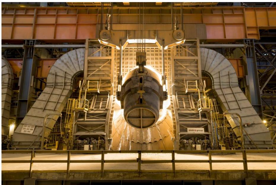
BOF-Konverter der SMS group, ausgestattet mit der wartungsfreien Lamellen-Konverteraufhängung.
