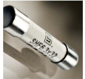
SCHURTER bietet die Gerätesicherung SHF 6.3x32 in zehn Nennströmen zwischen 1 und 8 A an. Das hohe Ausschaltvermögen von 1500 A bei einer Nennspannung von 500 VAC zeichnet die Sicherung aus. Neben einer Vielzahl von Anwendungen im Energie- und Industriebereich eignet sich die SHF 6.3x32 speziell zum Schutz von 3-Phasen-Systemen.
