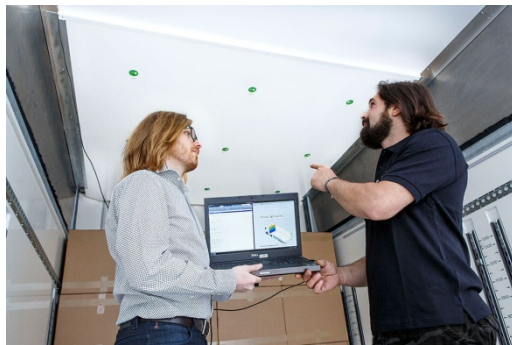
Im Van Eck Trailer integriertes Sensorpanel zur Bestimmung der Ladungshöhe und des Ladevolumens. Foto: Raapke/Fraunhofer LBF
