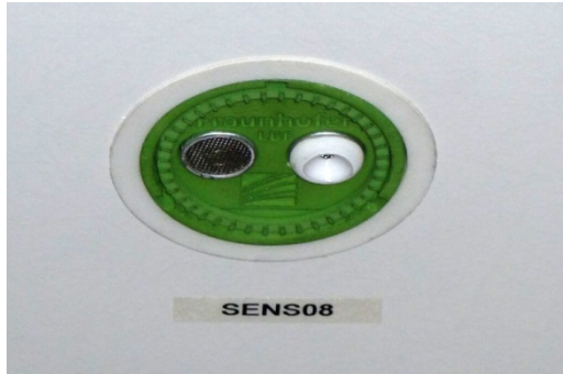
Einzelner Ultraschallsensor zur Bestimmung der Ladungshöhe. Foto: Fraunhofer LBF
