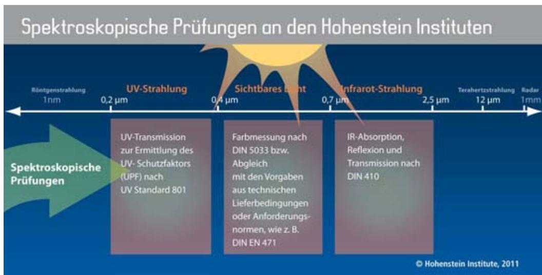
Anhand spektroskopischer Prüfungen kann ermittelt werden, inwieweit Textilien Strahlung absorbieren oder reflektieren und damit Funktionen wie UV-Schutz, Warnwirkung oder IR-Absorption erfüllen.
