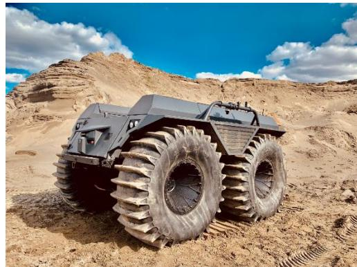
Ein weiteres Merkmal des Mission Master XT ist seine kontinuierliche Reifendruckregelanlage. Sie passt den Reifendruck je nach Bedarf und Gelände an. Das A-UGV zeichnet sich dabei durch hohe Ausdauer und Überlebensfähigkeit aus. Selbst zwei Zentimeter lange Löcher in den Reifen stoppen die Fahrt nicht.
