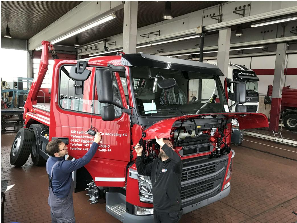
Einbau eines Abbiegeassistenzsystems durch die Werkstatt der LN Leithl Nutzfahrzeuge GmbH
