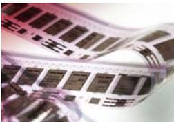
Gedruckte Logik-Schaltkreise für RFID-Transponder
