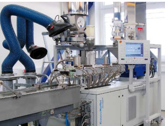
Verarbeitung von Biopolymeren mittels Extrusion im IfBB an der Hochschule Hannover
