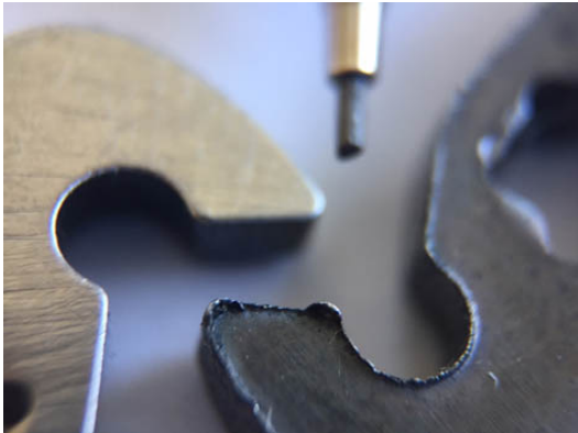
Bild Nr. 07-03 SY-WerkstückGrat.jpg. Der partiell anfallende Massivgrat wird prozesssicher entfernt und die gesamte Teilekontur bei einem autonomen Durchsatz von über 14.000 Teilen pro Stunde gleichmäßig verrundet.
