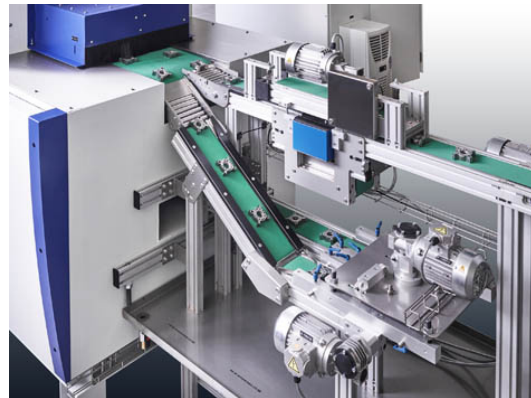
Bild Nr. 07-04 SY-Wendeeinheit.jpg. Durch intelligent gestaltete Umkehrschleifen können hoch schlagempfindliche Werkstücke beidseitig entgratet werden.
