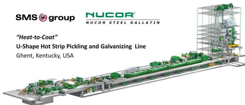
Die neue von der SMS group gelieferte Beiz- und Verzinkungslinie zeichnet sich besonders durch ihren kompakten, U-förmigen Aufbau, eine hohe Kapazität und einen großen Abmessungsbereich der Produkte aus.
