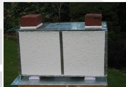
Labor-Prüfstand: S-WDVS versus WDVS 16. 11. 07, Standort: Düsseldorf Testvergleichsflächen: SW-Ausrichtung links: Dämmgleichrichter + Solaroberputz rechts: Dämmplatte + Silikonharzputz
