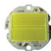
Multichip-Modul 288 LEDs
