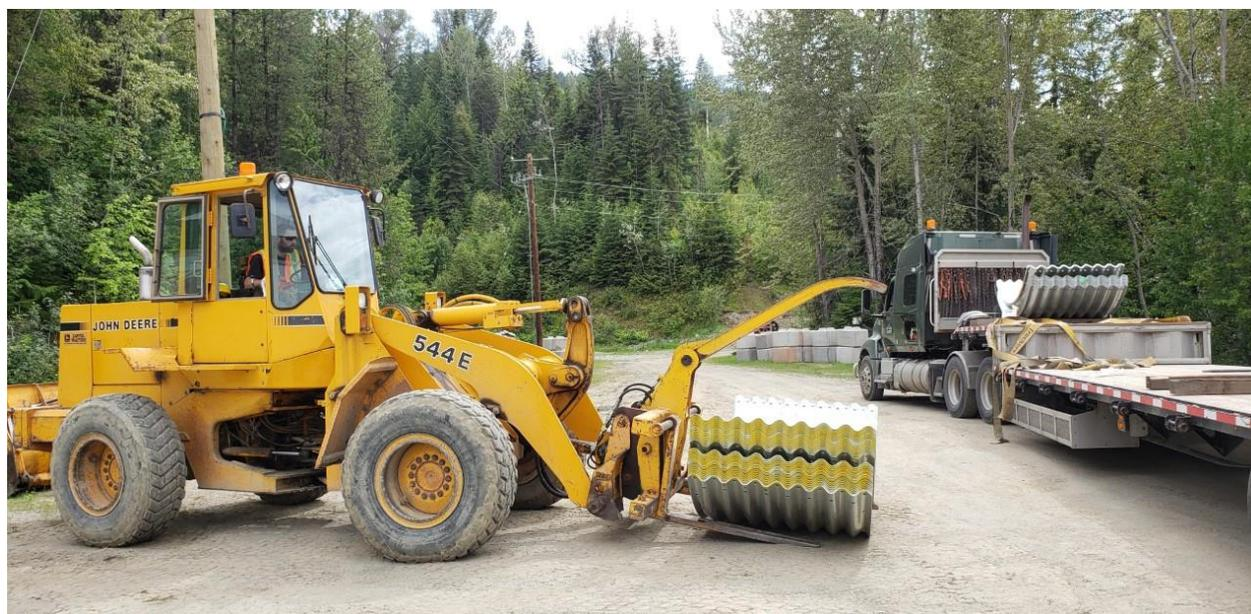
*Mine Kenville: Stahl-Abzugskanal für das neue 257-Portal*
