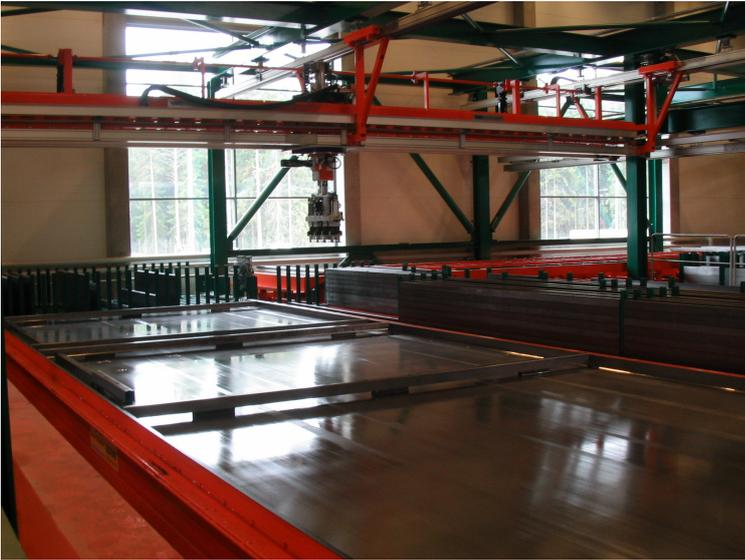
Automatisches Setzen der Schalungen durch den Schalungsroboter
