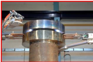
Abb. 6a: Arbeitsprobe zum Fügen eines Turbinenrotors für den nuklearen oder konventionellen Einsatz
