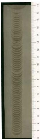
Abb. 3: Heißdraht-Engspaltschweißnaht, eine Schweißung (Strichraupe) pro Lage.
