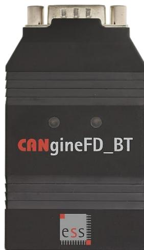
*CANgineFD\_BT* wartet mit einem leistungsfähigen 32-Bit Cortex-M4 Mikrocontroller auf, der mit 80 MHz getaktet wird und so CAN FD-Datenraten bis zu 10 Mbit/s unterstützt.
