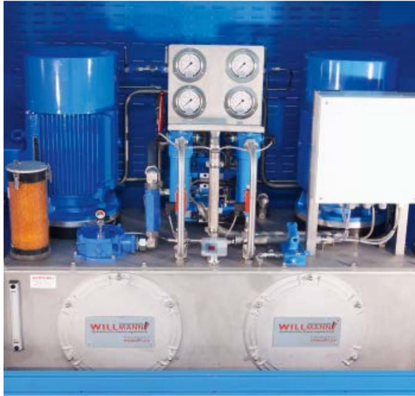
» Die Brücke wird innerhalb von 120 Sekunden um 2,7 Meter angehoben – die Kraft dafür kommt von zwei Motoreinheiten.
