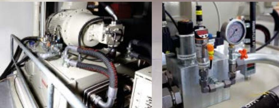
» Anstelle eines herkömmlichen Motors wurde ein Hydraulik-Motor eingesetzt.
