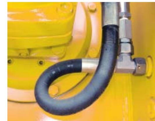
Auch Reparaturen sind absolut tabu. Zudem gibt es eine Kennzeichnungspflicht: Wer eine Hydraulik-Schlauchleitung herstellt, muss diese dauerhaft kennzeichnen mit Daten wie Hersteller, Herstellungsdatum und maximalem Betriebsdruck.
