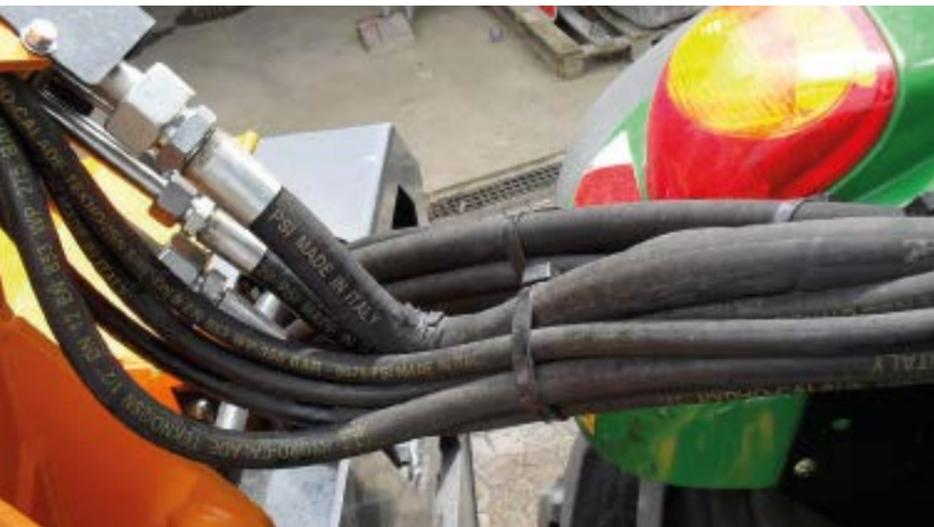
» Maschinenbetreiber sind verpflichtet, Hydraulik-Schlauchleitungen in regelmäßigen Abständen zu prüfen.
