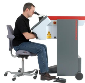
Abb. 3: Performance – auch in der offenen Variante für feinste Schweißungen von sperrigen Teilen verfügbar
