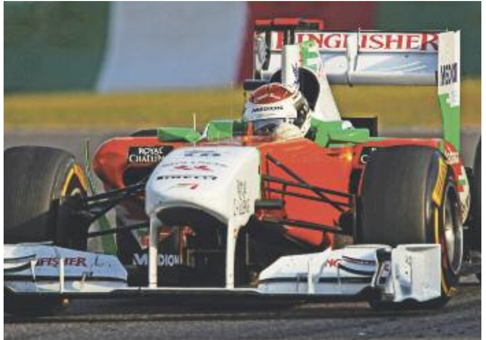
Für das Team Force India starteten 2011 der Deutsche Adrian Sutil (Bild) und der Brite Paul di Resta in den Läufen zur Formel 1-Weltmeisterschaft. Das Auto wird von einem Mercedes-„Kunden“-Motor angetrieben. Acht Zylinder, 2,4 Liter Hubraum, ca. 780 PS Leistung, Mindestgewicht: 640 kg
