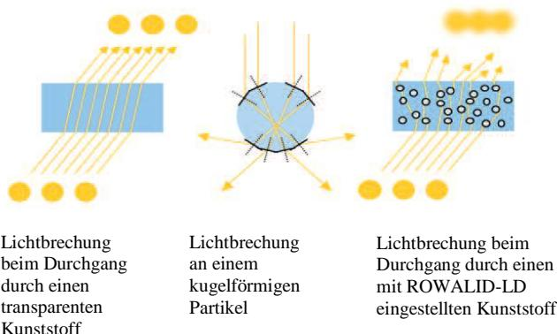
Diese Beobachtung hat die ROWA Masterbatch nun technisch umgesetzt, um transparente Kunststoffe wie PMMA, PS oder PC einzutrüben. Die Transparenz ist dabei der wichtigste Bestandteil der Entwicklung und muss erhalten bleiben. Denn Funktionsprinzip der Entwicklung ist es, das eintretende Licht nicht zu verschlucken oder zu reflektieren, sondern mittels unterschiedlicher Brechungsindizien nur von seinem geraden Weg umzulenken.
