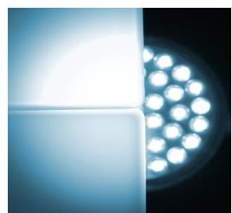
Der Vergleich ROWALID-LD (oben) gegen ein herkömmliches Streubatch (unten) zeigt deutlich die höhere Lichtausbeute bei gleicher Beladung (5 %) und Schichtdicke (3 mm).
