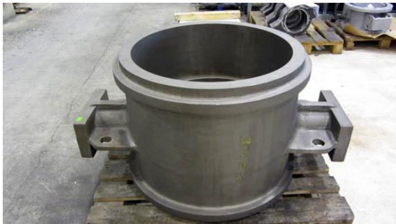
Bild Nr. 01-01 SH_OG-Rohling.jpg Rund 650 kg bringt der aus Stahlguss gegossene Rohling der Absperrklappe auf den Werkstücktisch des Bearbeitungszentrums.
