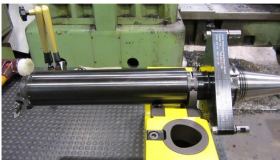
Bild Nr. 01-09 SH_OG-WzgLang.jpg Für einige Drehoperationen werden schwingungsgedämpfte "Silent Tools" von Sandvik eingesetzt. Diese werden mit dem abgestützten Drehstahlhalter von SHW direkt aus dem Werkzeugwechsler eingewechselt.
