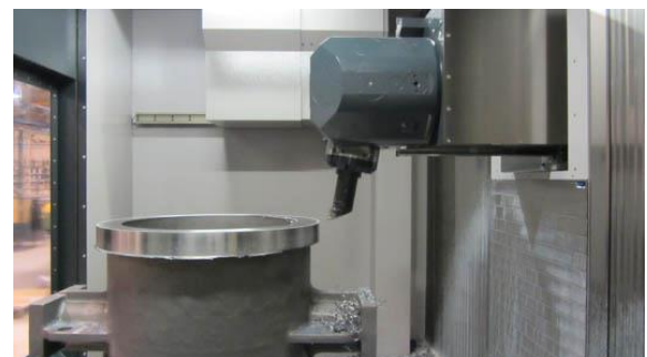
Bild Nr. 01-04 SH_OG-Position.jpg Der kompakte und kraftvolle Orthogonalkopf erreicht 64.800 Positionen.
