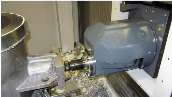
Bild Nr. 01-05 SH_OG-Fraesen2.jpg In einer Aufspannung möglichst viele Operationen durchführen erhöht die Präzision.
