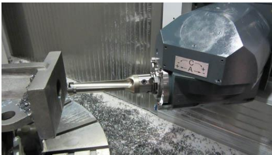
Bild Nr. 01-07 SH_OG-Bohren2.jpg Weil der Orthogonalkopf der UniSpeed 5T sehr kompakt ist, schwenkt er vollautomatisch in jede gewünschte Position, ohne den Arbeitsraum einzuschränken.
