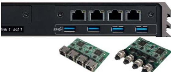
1 High Speed Sockel für z.B. 4 x 10GLAN (RJ45), 4 x LAN (RJ45), 4 x LAN (M12), 4 x PoE (RJ45), 4 x PoE (M12) Module
