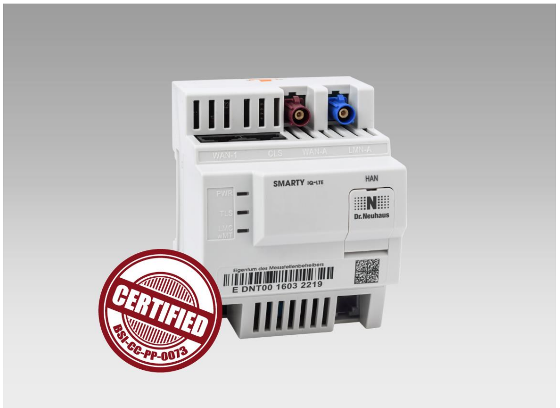
Abbildung 2: Das BSI-zertifizierte Smart Meter Gateway Siconia™ SMARTY IQ (Bildquelle: Sagemcom Dr. Neuhaus GmbH)
