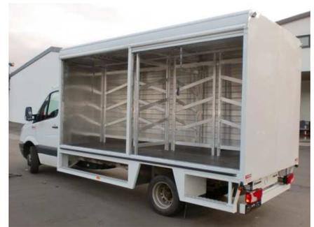
Der schnelle Zugang zur Ware und eine bewährte robuste Aufbautechnik in Leichtbau favorisieren die ORTEN Hybrid Ganz-Alu Aufbautechnik. Mit einem Eigengewicht von nur ca. 800 kg und einer in Ganz-Aluminium gefertigten Aufbautechnik entspricht der ORTEN Hybrid den in den USA tausendfach bewährten Vorbildern.
