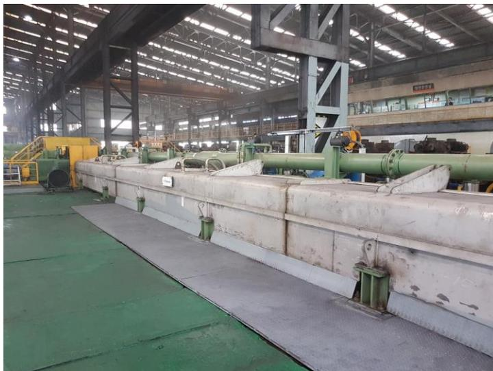
Abschrecklinie für Betonstahl – Kühlwasserkästen.
