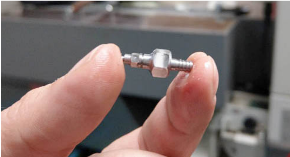
Bild Nr. 06-01 AO_RW-E-Ventil.jpg Ein anspruchsvolles Teil fertigt die Ralf Weisheit GmbH für eine Hightech-Fahrradbremse.
