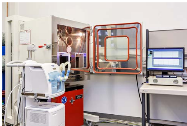
In der experimentellen Umweltsimulation werden die Displays in einer Klimakammer und mit einem Schwingerreger (Shaker) belastet. Foto: Fraunhofer LBF
