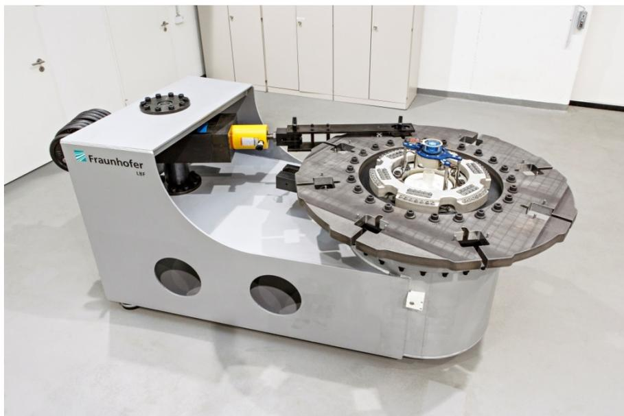
Neu entwickelter Prüfstand zur Kalibrierung von LKW-Messrädern für hohe Lasten.
