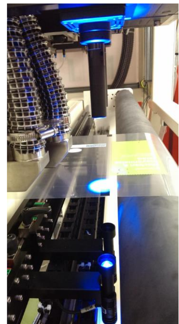
Abb. 1: VisionPerfoControl – ROFINs Hochleistungskamerasystem zur Erfassung und Bemessung mikroperforierter Löcher in transparenter Folie
