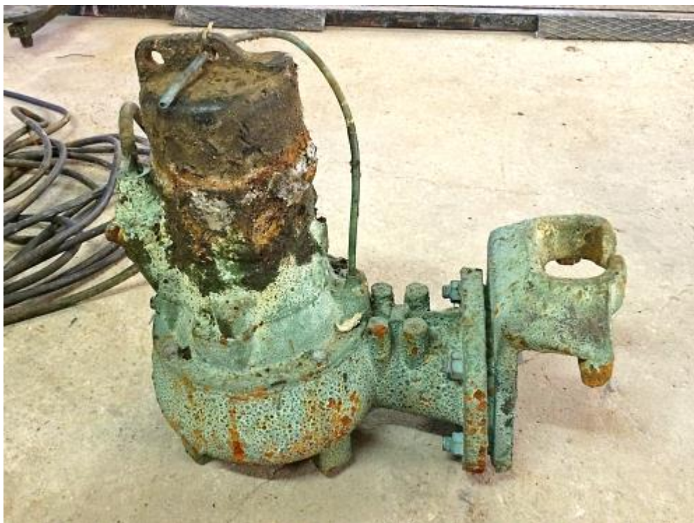
Bild 2: Pumpenkörper nach einer Laufzeit von ca. 16 Monaten mit starken Korrosionsschäden.
