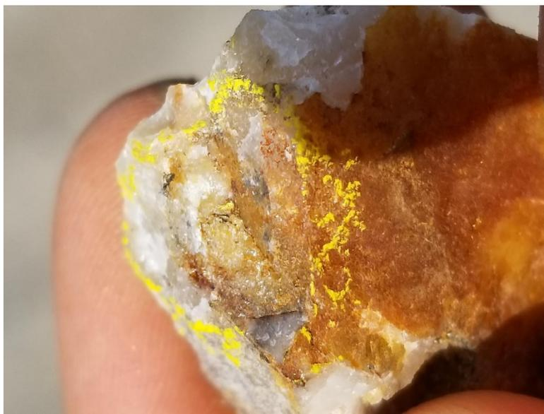
Foto eines Stücks des Bohrkerns aus Bohrloch 2019-19 mit sichtbarem Gold in rostigem Quarz.
