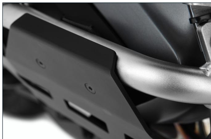
Die unkomplizierte Montage des aus hochwertigem Aluminium gefertigten Schutzsystems erfolgt unmittelbar und leicht zugänglich am originalen Motorschutzbügel
