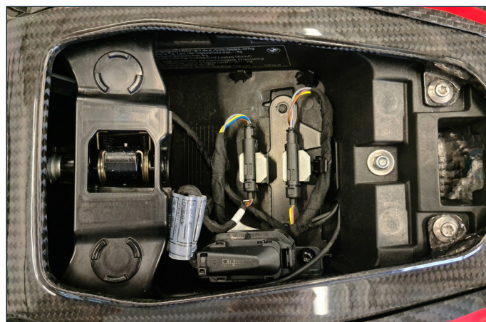
Die beim Original in der Seitenverkleidungen der Sitzbank nur schwer zugänglichen Kabelverbindungen und -stecker wurden von Wunderlich gut zugänglich unter dem Beifahrersitz/Beifahrersitzabdeckung verlegt
