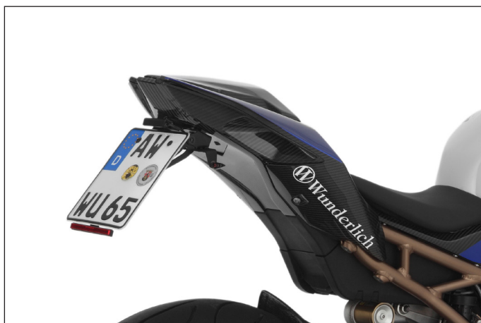
Spart beim Rennen oder Rennstreckentraining Gewicht und verbessert die Aerodynamik - der leicht abnehmbare »TRACKDAY« -Kennzeichenträger
