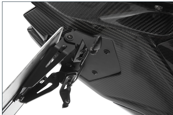
Eine passgenaue, schalenförmige Verkleidung, die zum Lieferumfang des Kennzeichenträgers gehört, verschließt dauerhaft die unter der Sitzbank entstandene Öffnung
