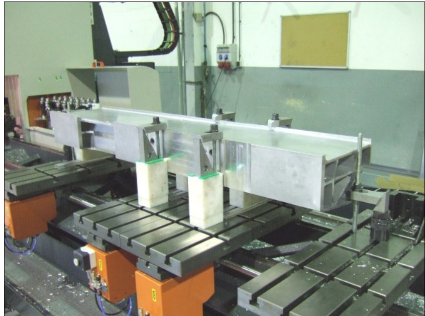
Zur Zusatzausstattung, die Maschinenhersteller elumatec anbietet, gehören T-Nutenplatten. Auf den Nutenplatten werden die schweren Profile sicher gehalten.
