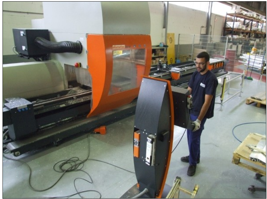
Das SBZ 151 kann auch im Pendelbetrieb eingesetzt werden, seine mitfahrenden Werkzeugmagazine erlauben schnelle Wechselzeiten. Die übersichtliche Programmiersoftware PUMA-System® unterstützt Maschinenbediener Eduard Plana Pages.
