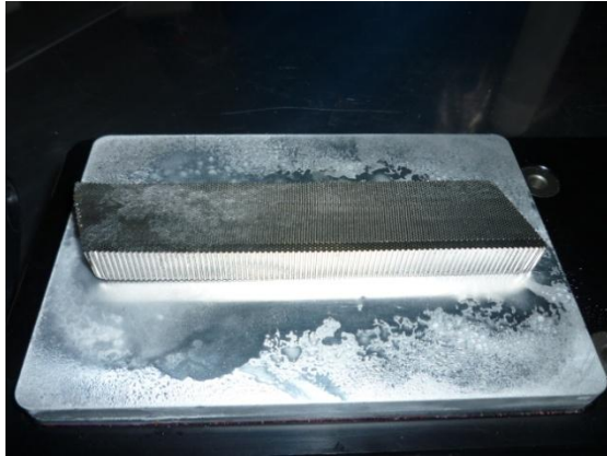
Bild 2: zeigt eine Gefrierspannplatte mit Werkstück während des Spannvorgangs
