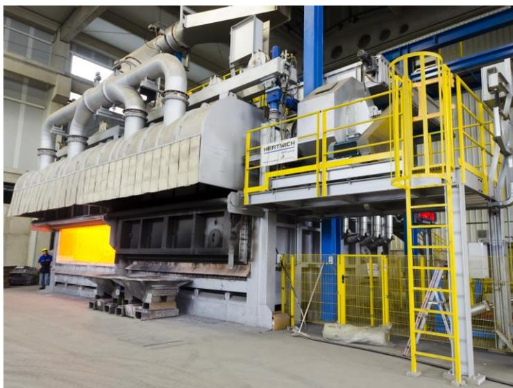
Hertwich-Mehrkammerschmelzofen Ecomelt PS.
