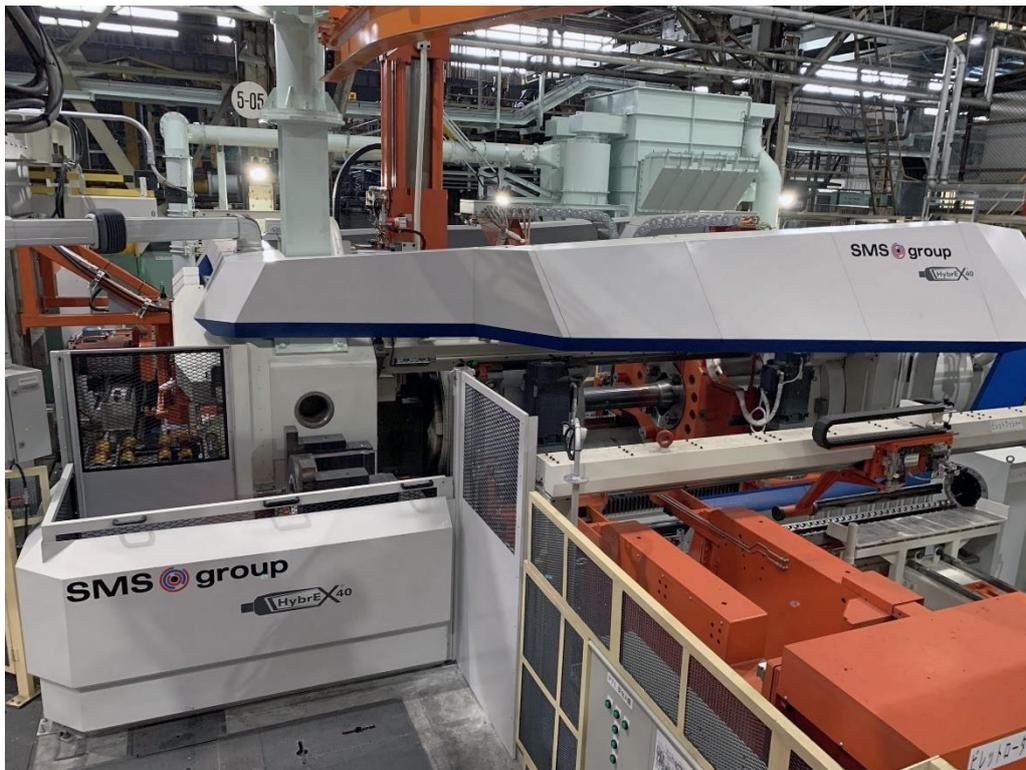
Die neue, von SMS group gelieferte Strangpresslinie im Werk Nagoya der japanischen UACJ Extrusion Nagoya Corporation: Die HybrEx®40-Pressen sind das zentrale Element der Linie.
