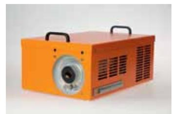
Die Messung erfolgt ohne Emission gefährlicher Strahlung und ist robust gegenüber Änderungen des Arbeitsabstands oder Verkippung des Prüfobjekts.
